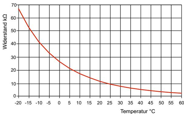
Abb. 9.1: Fühlerkennlinie NTC-10
