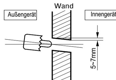
Für die sichere Abfuhr des Kondensates ist der Kondensatablauf so zu verlegen, dass kein Frostansatz entstehen kann. Die Frostgrenze kann je nach Klimaregion variieren. Es sind die Vorschriften der jeweiligen Länder zu berücksichtigen.
