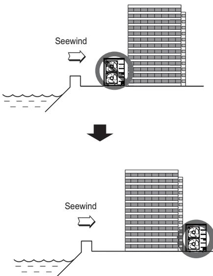
Fall 2: Falls das Außengerät in Seewindrichtung montiert wird, errichten Sie einen Windschutz, um den Seewind abzufangen.
