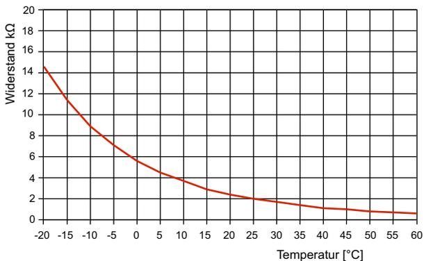
Abb. 9.2: Fühlerkennlinie NTC-2 nach DIN 44574 Außentemperaturfühler
