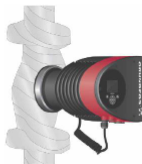
321 Abbildung: Dämmung bauseits! Niemals die Elektronikeinheit dämmen!
