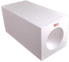
Die eckige **DL 40** Wanddurchführung besteht zur Vermeidung von Kältebrücken aus dem Wärmedämmstoff EPS. Das integrierte Gefälle zur Ableitung von Kondensat sowie das einfache Anpassen an die Wandstärke erleichtern die Installation. Die Montage während der Rohbauphase erfolgt durch Einmauern, alternativ durch eine Öffnung (mind. 220 x 220 mm).
