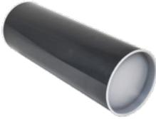
Die runde **DL 40** Wanddurchführung 160 mm ist zur Installation in Kernlochbohrungen 162 mm vorgesehen. Die Wanddurchführung rund ist in der Länge 500 mm verfügbar und besteht aus PVC-U.
