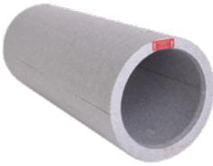
Die wärmegeädämte **DL 40** Wanddurchführung rund Neopor® kann nach erfolgter Montage mühelos mit einem Messer gekürzt werden. Das integrierte Gefälle ermöglicht den Abfluss von Kondensat selbst bei waagerechtem Einbau. Die Wanddurchführung rund ist in den Längen 495 oder 1000 mm verfügbar.
