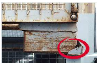
Verbogene Bodenrahmen oder FüÙe
