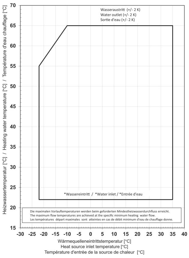
\*Bei Luft/Wasser-Wärmepumpen stellt die minimale Heizwassertemperatur die Mindest-Rücklauftemperatur dar
