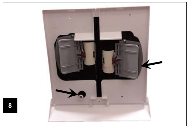
Abb. 3.8 Das Lüftungsgerät passgenau einschieben, Kondensatstutzen und Außenklappen müssen bündig sein. Am besten von außen kontrollieren.
