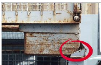
Verbogene Bodenrahmen oder FüÙe
